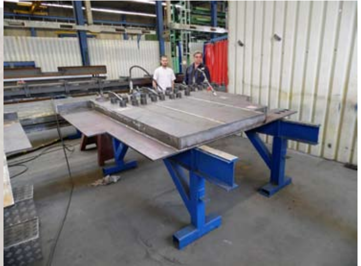
Druckprobe der neuen Müllschacht-Seitenwand
